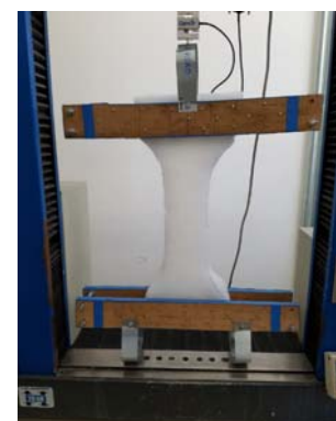
c. Ensaio de resistência à tração longitudinal
