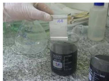
c. Ensaio de massa do revestimento de zinco
