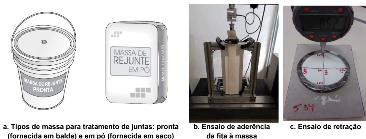
Figura 7 – Tipos de massas utilizadas para tratamento de juntas e detalhe de ensaios
