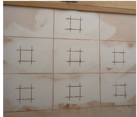
a) Demarcação e corte dos corpos de prova
