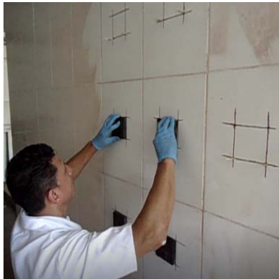
b) Fixação das pastilhas metálicas sobre os corpos de prova para
