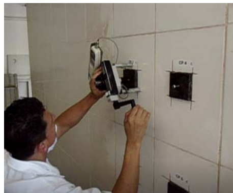
c) Acoplamento do equipamento de tração nas pastilhas metálicas sobre os corpos de prova
