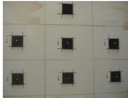
b) Fixação das pastilhas metálicas sobre os corpos de prova para
