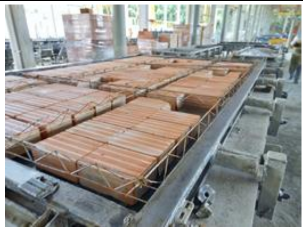
Figura 10 – Detalhe dos blocos cerâmicos entre as armaduras
