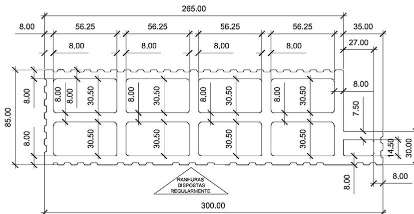
Figura 02 – Detalhe da lajota cerâmica (300mmx150mm)
