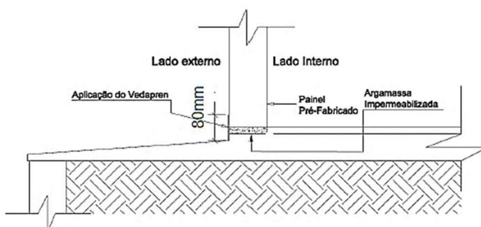
Figura 36 – Detalhe da emulsão acrílica nas bases das paredes externas
