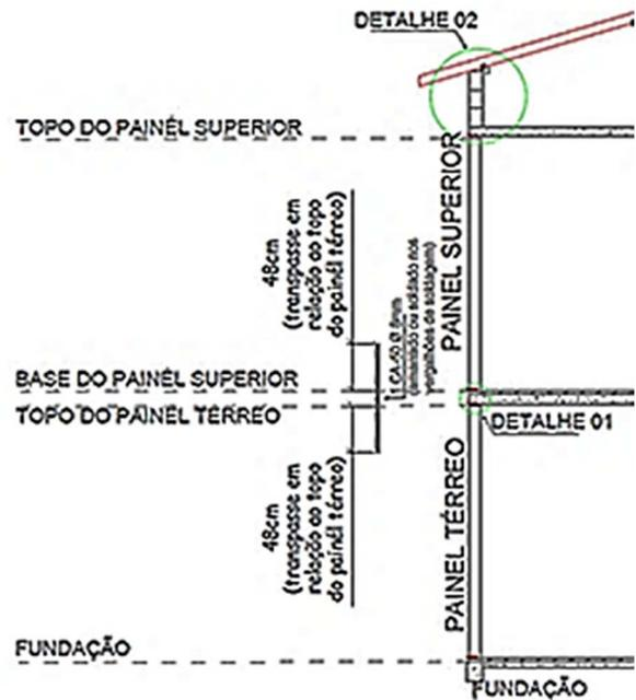
Figura 26 – Ligações entre dois painéis e barra de transpasse entre painel do pav. térreo e painel do pav. superior.
