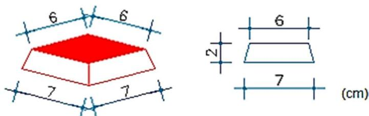
Figura 18 – Desenho esquemático do calço de argamassa.
