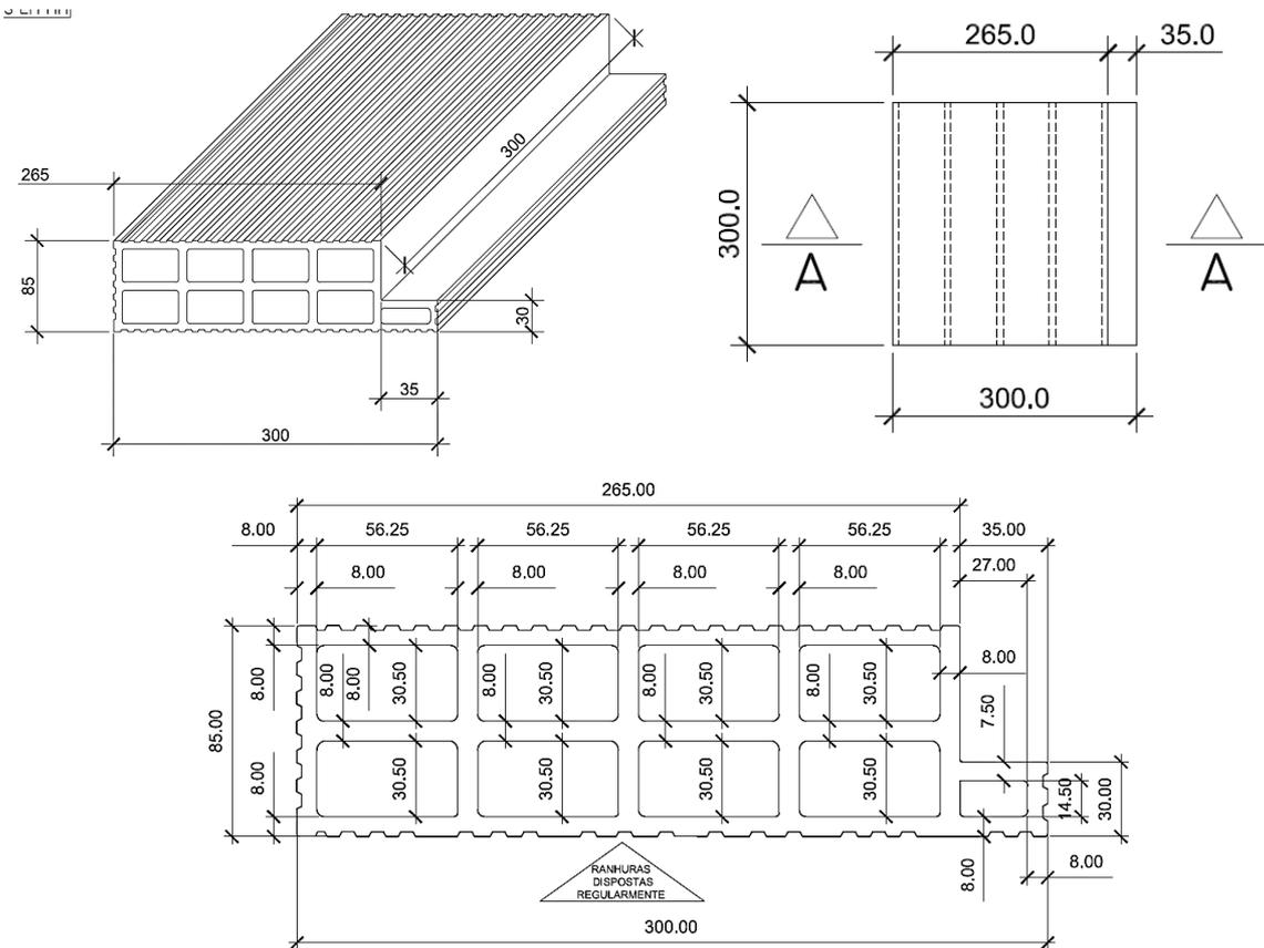
Figura 01 – Detalhe da lajota cerâmica (300mmx300mm)
