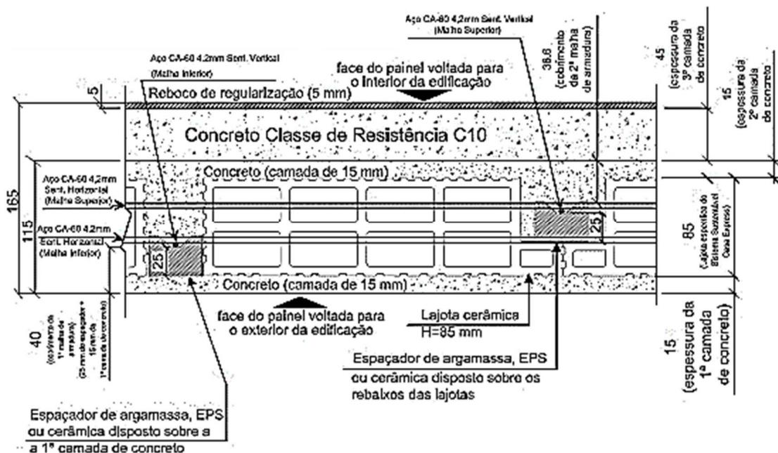
Figura 17 – Seção do painel com 165mm de espessura.
