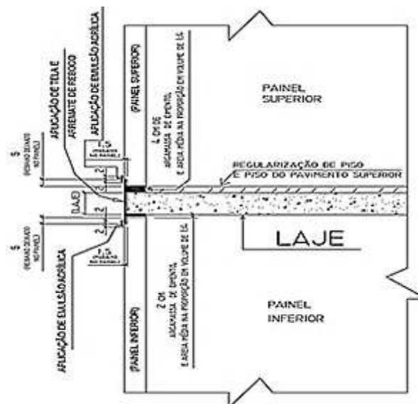
Figura 31 – Desenho esquemático do encontro entre painéis e laje.
