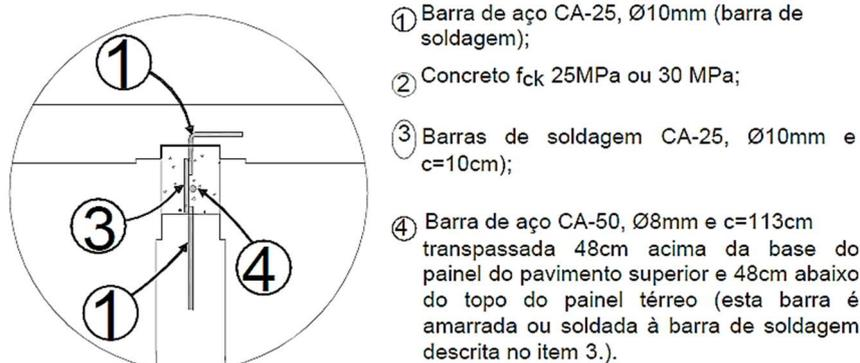
Figura 23 – Detalhe esquemático da ligação entre dois painéis em “T”.
