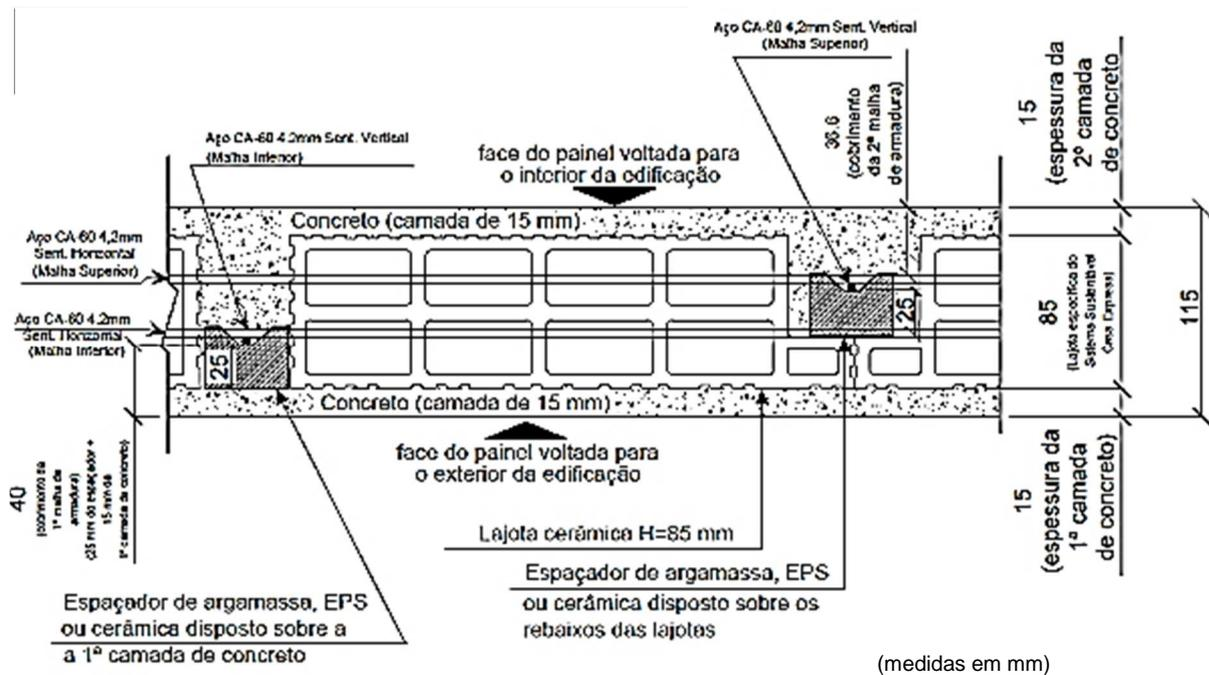
Figura 16 – Seção do painel com 115mm de espessura (regiões de classe ambiental III).
