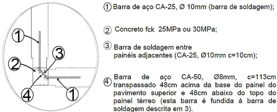
Figura 22 – Detalhe esquemático da ligação entre dois painéis em “L”.
