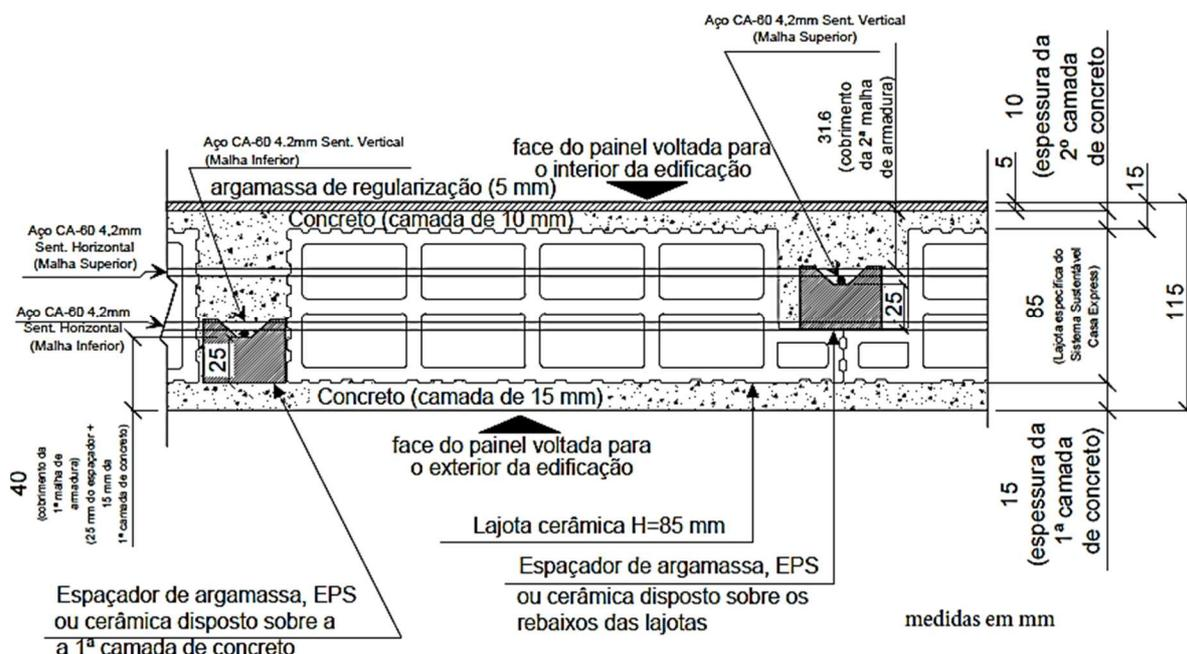
Figura 15 – Seção do painel com 115mm de espessura (regiões de classe ambiental I e II).
