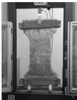
b. Ensaio de resistência à tração longitudinal
