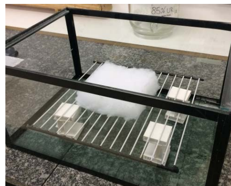
c. Ensaio de determinação da absorção de umidade
