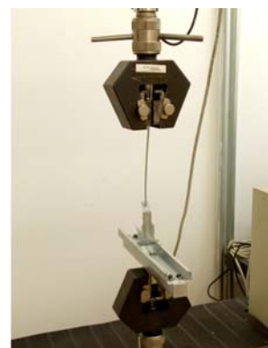
b. Ensaio de resistência à tração pendural + perfil
