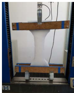
b. Ensaio de resistência à tração longitudinal
