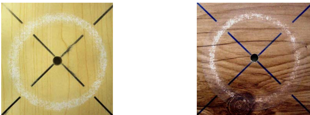
Figura 6 – Desgaste por abrasão em corpos de prova (100x100mm) de pisos laminados.
